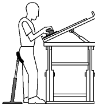
Figure 13 - Surface de travail inclinée
